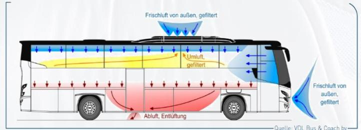
Die temperierte Luft mit hohem Frischluftanteil wird von oben eingeblasen und über ein effizientes Abluftsystem wieder aus dem Fahrzeug befördert.
